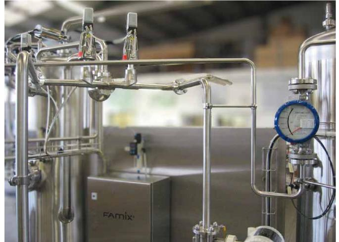
CO<sub>2</sub>-Messung mittels Schwebekörper. Durchflussmessgerät für die Bestimmung der CO<sub>2</sub>-Zugabe zur Reduzierung des Rest O<sub>2</sub>-Wertes auf < 0,1 mg/l.
